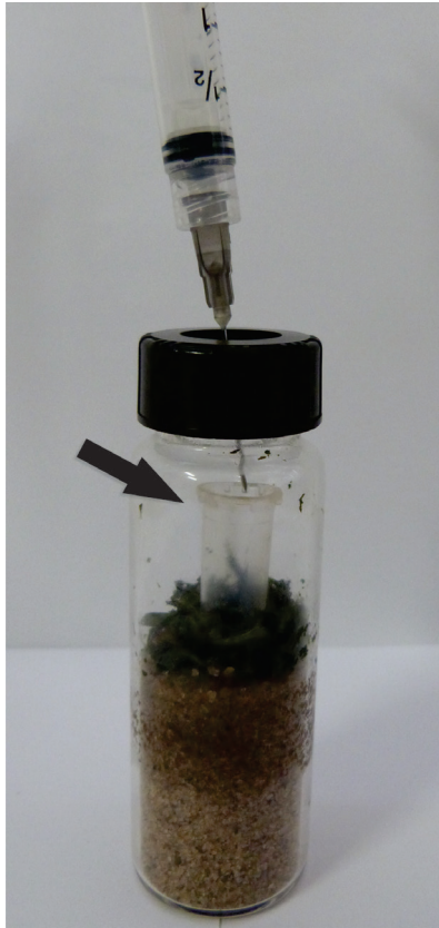
Figura 1. Material usado na avaliação da toxicidade de voláteis emitidos por plantas a juvenis de segundo estágio de Meloidogyne incognita em frasco Supelco™SPME. A tampa rosqueada expõe, no topo, a película de silicone. No frasco contém areia, macerado vegetal na sua superfície e um microtubo nela aterrado até a metade. Seta indica o eppendorf colocado no seu interior, que receberá, por injeção, a suspensão de juvenis de segundo estágio de Meloidogyne incognita .
