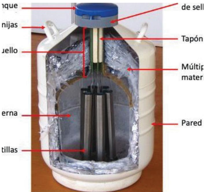
Figura 2. Estructura interna del tanque de nitrógeno líquido. Créditos: Foto original cortesía del Dr. Alejandro Ojeda, University of Florida
