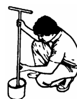
Figura 3. Coloque 5 a 10 muestras en una cubeta plástica; mezcle, seque y transfiera a una bolsa.
