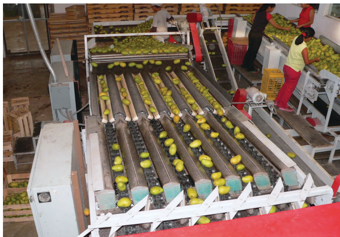
Classificação automática por tamanho da fruta na linha de classificação
