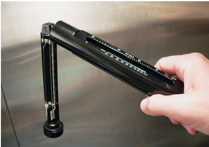
Usando um psicrômetro giratório para medir a umidade relativa do ar
