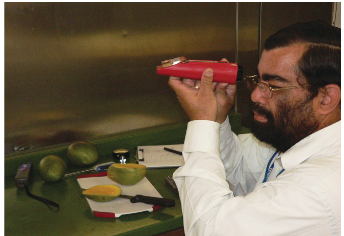
Medindo o SST da manga com um refratômetro
