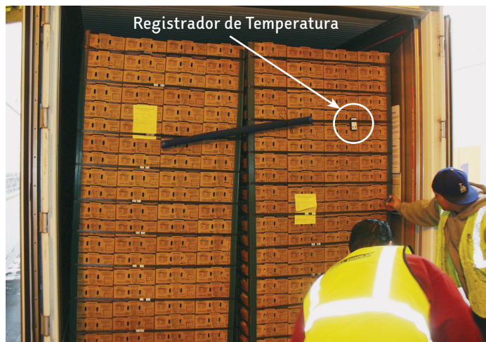
Recuperando um registrador de temperatura na chegada da carga
