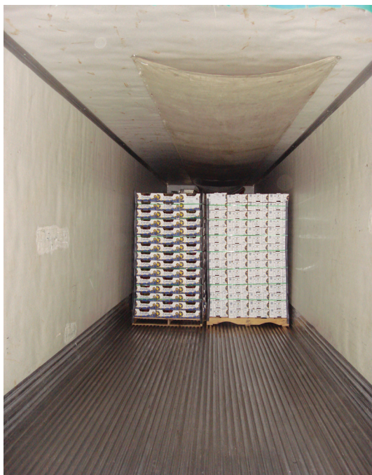
Interior de um caminhão refrigerado sendo carregado; o duto de suprimento de ar é mostrado
