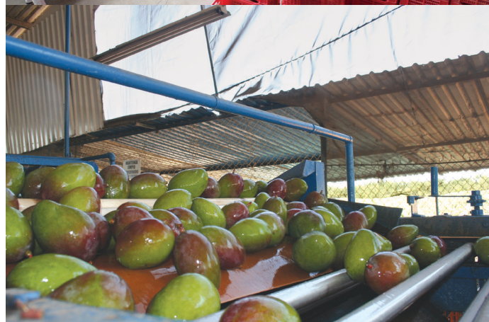
Classificação inicial da fruta por peso (alto) e por dimensão (abaixo)
