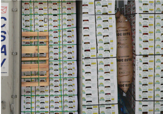
Uso de bloqueadores e sacos de ar para estabilizar cargas em contêineres e caminhões refrigerados. Note o registrador de temperatura à esquerda na foto
