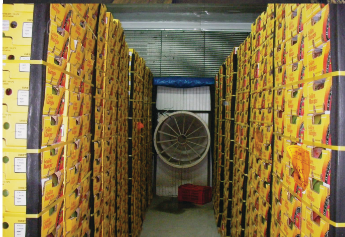
Túnel de resfriamento com ar forçado
