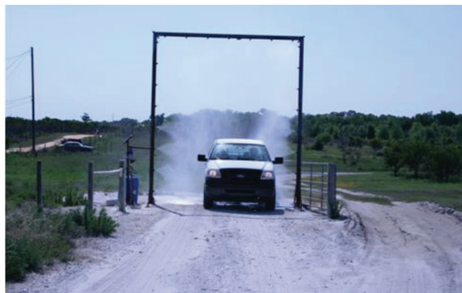
Figure 11b. Estación automática de descontaminación de vehículos y equipamiento.
